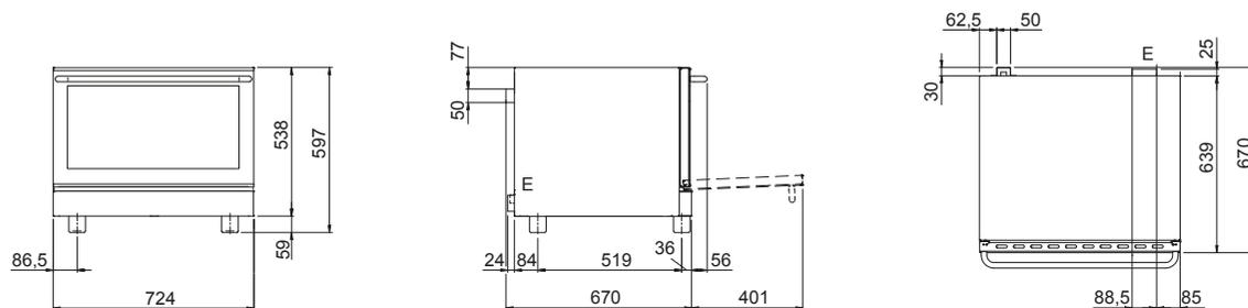
E - Elektrobetrieb    D - Wasserablauf Ø 30 mm    H2O - Wasserbefüllung 3/4"
