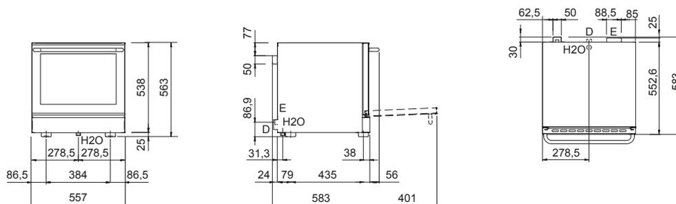
E - Elektrobetrieb    D - Wasserablauf Ø 30 mm    H2O - Wasserbefüllung 3/4"
