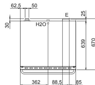
E - Elektrobetrieb H2O - Wasserbefüllung 3/4"
