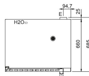
**E** - Elektrobetrieb    **D** - Wasserablauf Ø 30 mm    **H2O** - Wasserbefüllung 3/4"
