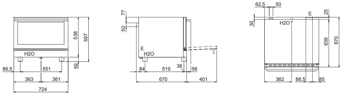
E - Elektrobetrieb    H2O - Wasserbefüllung 3/4"
