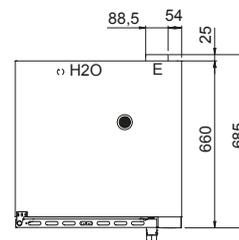
E - Elektrobetrieb    D - Wasserablauf Ø 30 mm    H2O - Wasserbefüllung 3/4"
