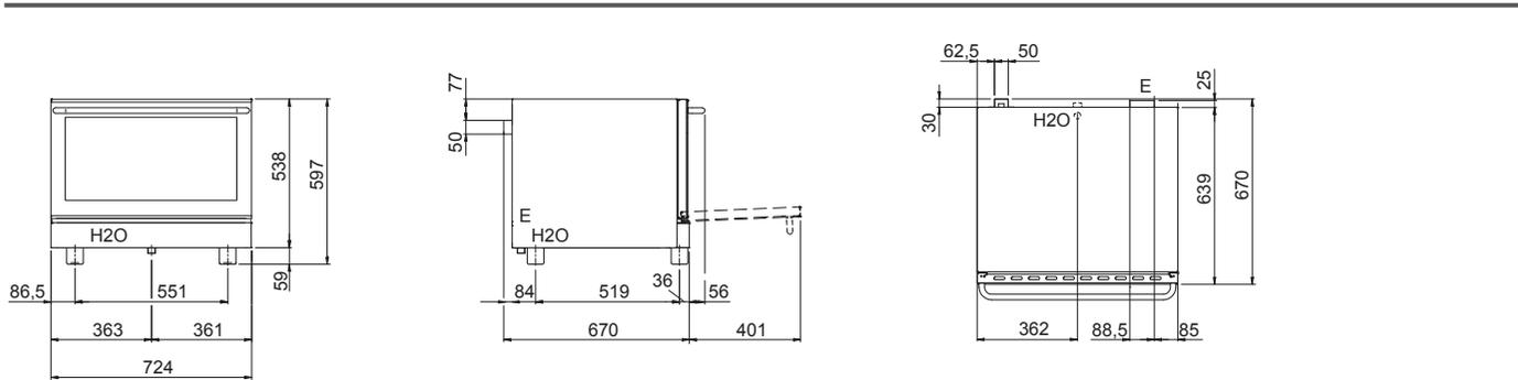
E - Elektrobetrieb H2O - Wasserbefüllung 3/4"
