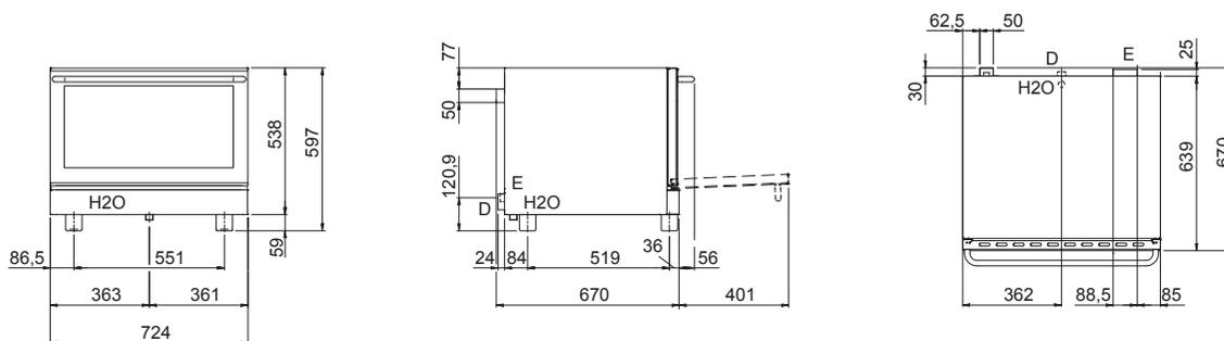
E - Elektrobetrieb D - Wasserablauf Ø 30 mm H2O - Wasserbefüllung 3/4"
