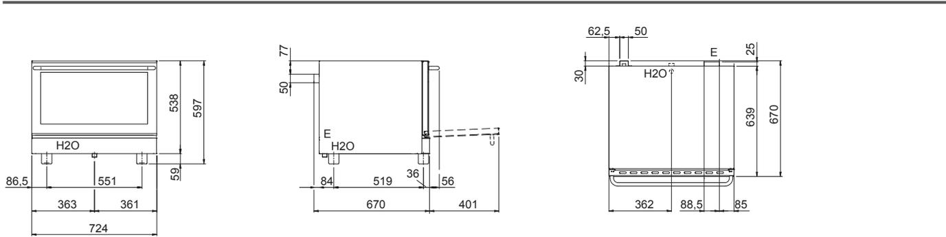
E - Elektrobetrieb H2O - Wasserbefüllung 3/4"
