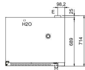
E - Elektrobetrieb D - Wasserablauf Ø 30 mm H2O - Wasserbefüllung 3/4"
