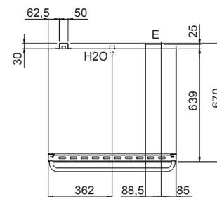
E - Elektrobetrieb H2O - Wasserbefüllung 3/4"
