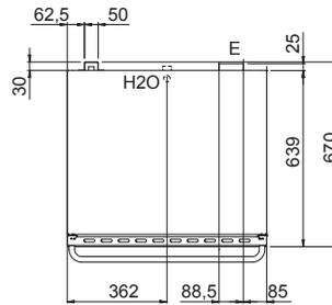
E - Elektrobetrieb H2O - Wasserbefüllung 3/4"
