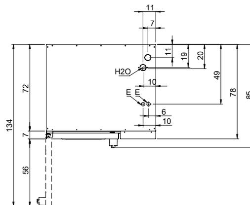
E - Elektrobetrieb D - Wasserablauf Ø 50 mm H20A - Zulauf Wasser 3/4"
