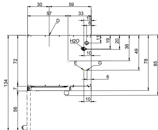
G - Gasanschluss 228-1 G 3/4 E - Elektrobetrieb D - Wasserablauf Ø 50 mm H2OA - Zulauf Wasser 3/4"
