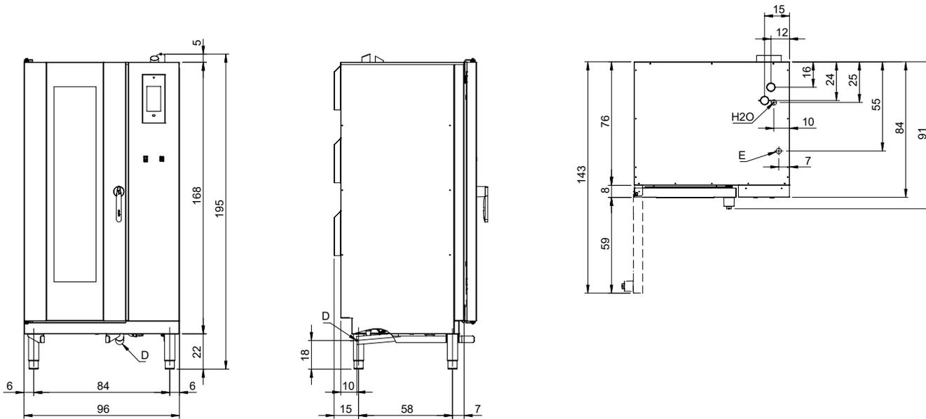
E - Elektrobetrieb D - Wasserablauf Ø 50 mm H2OA - Zulauf Wasser 3/4"
