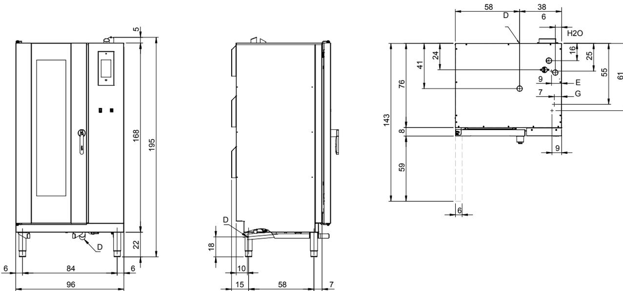
G - Gasanschluss 228-1 G 3/4 E - Elektrobetrieb D - Wasserablauf Ø 50 mm H2OA - Zulauf Wasser 3/4"
